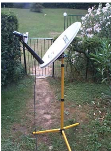
La parabola montata su un treppiedi e nel suo fuoco il convertitore LNB.
